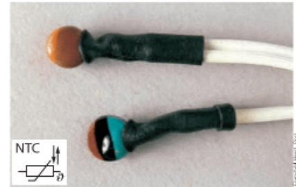
Wenn ein Temperaturfühler (Heißleiterwiderstand) erwärmt wird, nimmt sein Widerstandswert stark ab.
